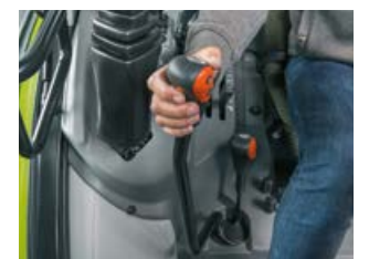
Mit REVERSHIFT Ausstattung: Bedienung der elektronischen Kupp-lung per Knopfdruck am Schalthebel.
