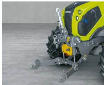
Der optionale Frontkraftheber mit 3,2 t Hubkraft und die Frontzapfwelle erweitern das Einsatzspektrum des ELIOS.
