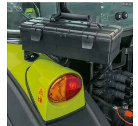
Das Zubehör ist immer griffbereit in der Werkzeugkiste am Heckkotflügel.
