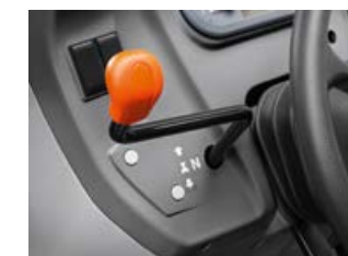
Die Wendeschaltung erfolgt jeweils griffgünstig links neben dem Lenkrad, wahlweise elektronisch mit REVERSHIFT oder mechanisch.
