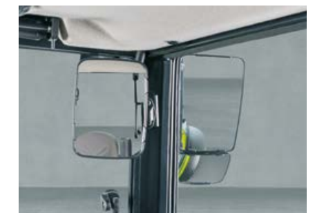
Zusätzlich zum großflächigen Spiegel ist ein Weitwinkelspiegel für mehr Sicherheit im Straßenverkehr verfügbar.
