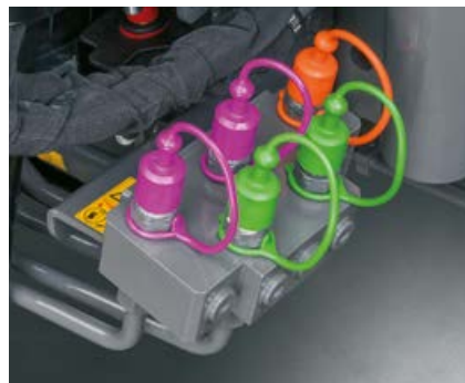
Vorne rechts an der Kabine sind bis zu vier hydraulische Anschlüsse sowie ein freier Rücklauf verfügbar.
