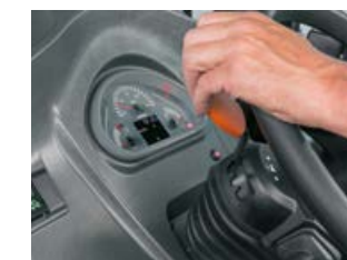
Die Wendeschaltung erfolgt jeweils griffgünstig links neben dem Lenkrad, wahlweise elektronisch mit REVERSHIFT oder mechanisch.
