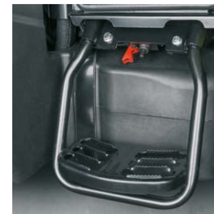
Der Batterietrennschalter ist griffgünstig am linken Einstieg platziert. (außer ELIOS 210)
