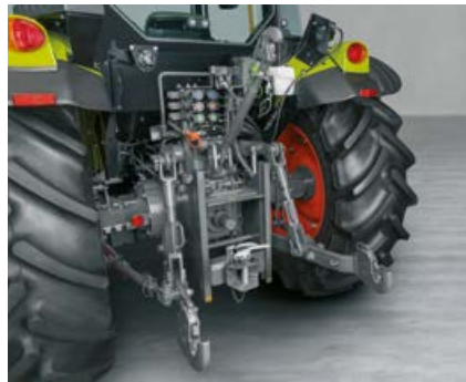
Mit 3,2 t maximaler Hubkraft kommt der ELIOS im harten Alltag bestens zurecht.
